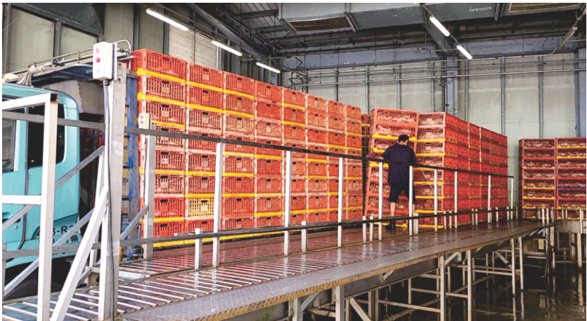
禽籠平台下車履帶移動
