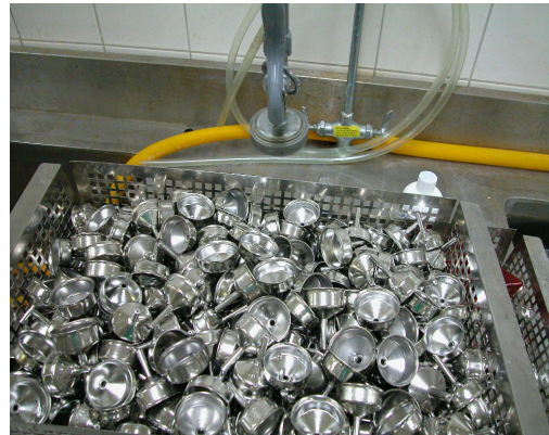
圖 4.62 不銹鋼水瓶頭經超音波震盪機清洗後再以大量清水沖洗
