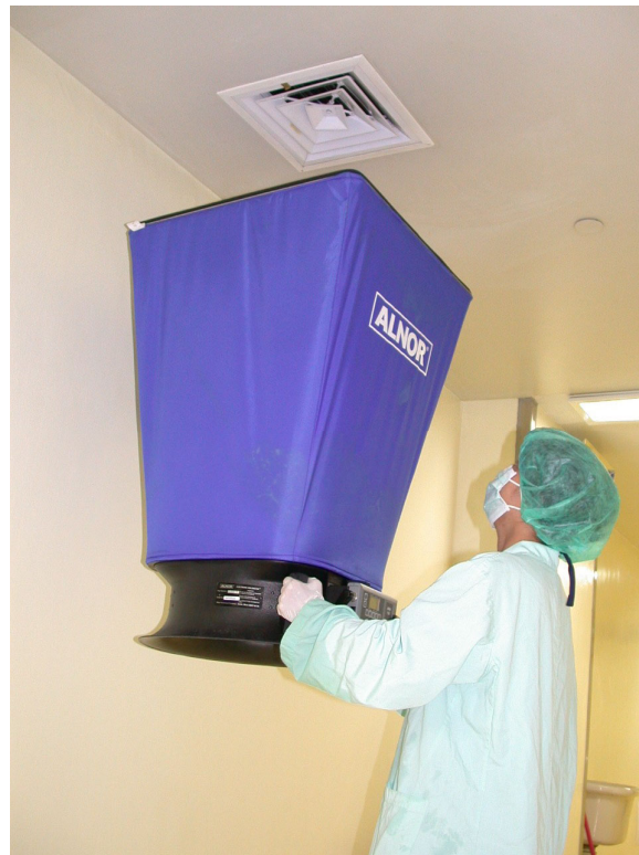
圖 4.6 測量房內進出氣流之風速計
