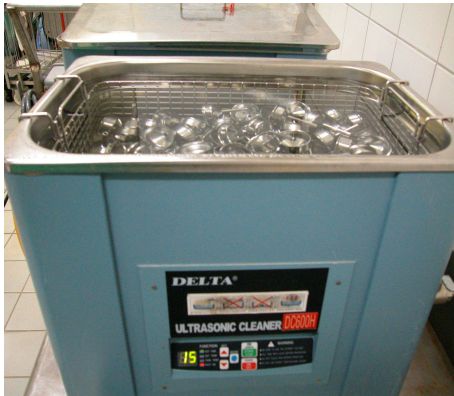
圖 4.61 不銹鋼水瓶頭利用超音波震盪機加熱清洗
