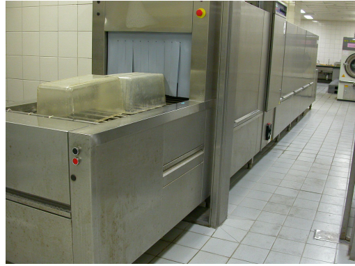
圖 4.57 鼠飼育盒經隧道式洗籠機清洗後，由乾淨出口送出
