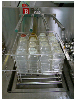
圖 4.64 水瓶充填機及水瓶架
