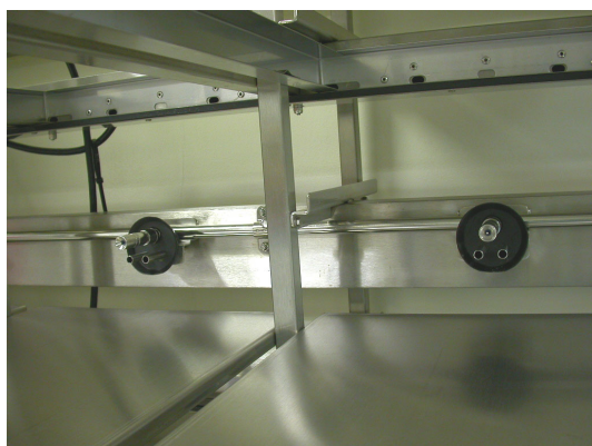
圖 4.38 自動給水系統-給水閥
