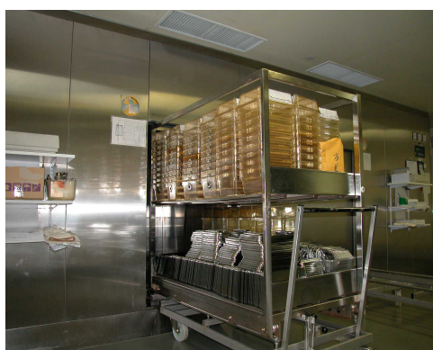
圖 4.46 雙門式高溫高壓消毒鍋 (滅菌前)
